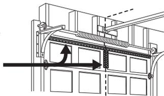
**REMARQUE :** Bon nombre de nécessaires de renforts de porte prévoient la fixation directe de l'axe de chape et de la biellette de porte. Dans ce cas, le support de porte ne sera pas nécessaire; passer à l'étape suivante.
